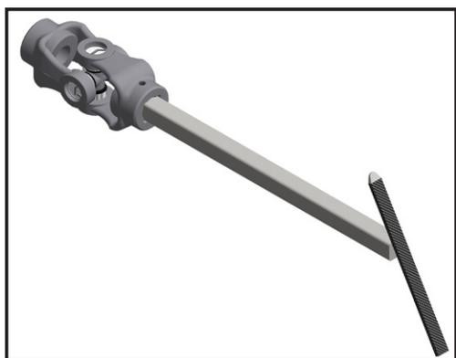
• Remova as rebarbas deixadas pela operação de corte e também limalhas deixadas pelo processo de rebarbação. Para isso, use uma lima e em seguida lubrifique o macho com uma camada fina de graxa.
